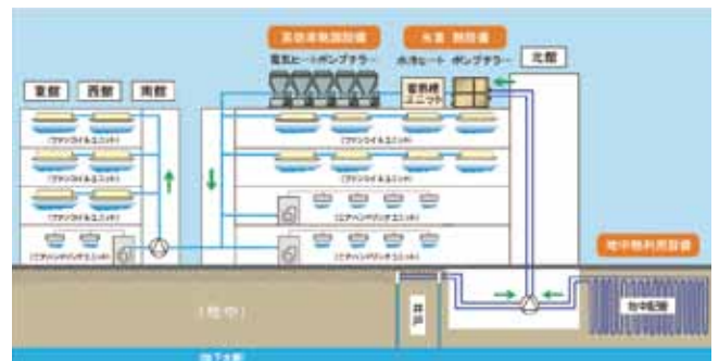
「地中熱利用空調設備」
