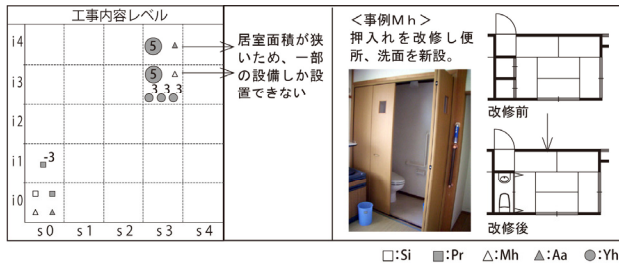
Fig.6 住戸内に必要な設備
