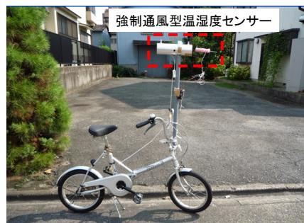
Photo 3 センサーを装備した移動観測用自転車
