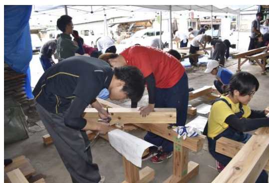
(名城加子母木匠塾) 岐阜県中津川加子母木匠塾へ参加した際の墨付けの様子
