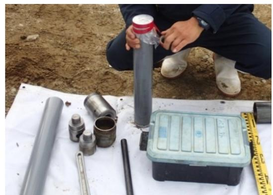
Fig.14 塩ビ管 (VU65, 内径 71mm)
