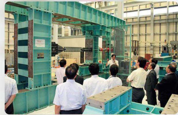
大型耐震構造実験用フレーム
