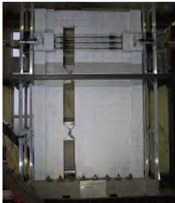
ドア開口を持つ耐震壁の実験。左右から地震力を加えた。
