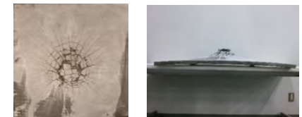
写真5 CU①最終状態 写真6 CU①載荷後側面
