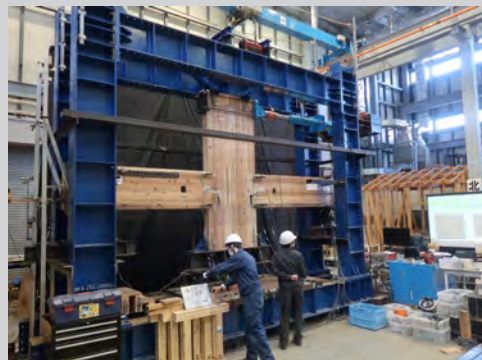
中高層木造建物の開発実験の様子
