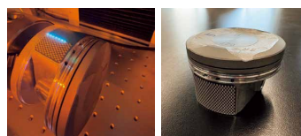
UVレーザーによるピストン加工事例
