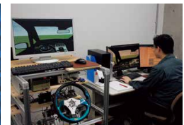
楊研 手動・自動運転リアルタイム シミュレーションシステム
