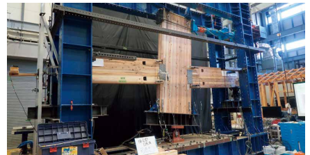
CLT 接合部実験
