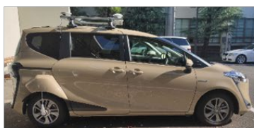
名城大学で保有している試験車両 車両のループにGNSSアンテナを中心と した位置推定用のセンサが設置されて いる
