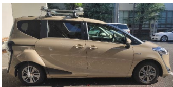
名城大学で保有している試験車両 車両のルーフにGNSSアンテナを中心とした位置推定用のセンサが設置されている
