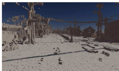
名古屋市の住宅街で MMS により計測した高精度地図を読み込んだシミュレータ画面
