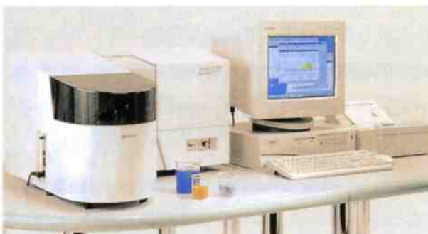
図3. リサイクル用粉体の粒度を分析する装置
