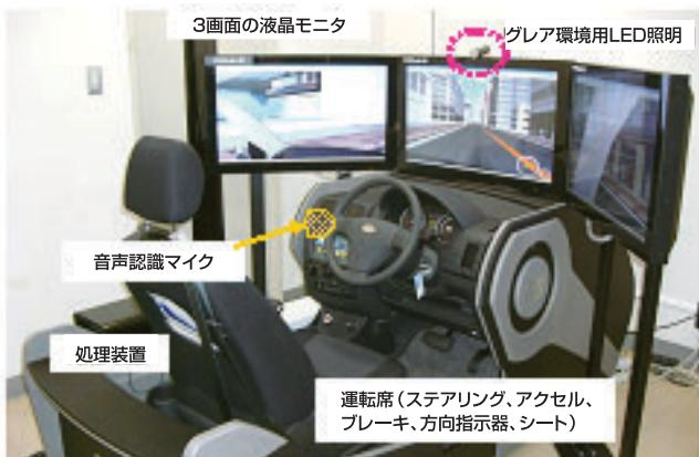
グレア環境用LED照明、音声認識用マイクおよび処理装置から構成される（下図）。このシミュレータでは、実際の運転状況に近い模擬映像を表示し、運転操作により模擬運転を行うことができる。従来のシミュレータに比べて、様々な運転状況（市街地、高速道路、自動車教習所の教習コースなど）を自由に再現できることが特徴である。模擬映像では、信号、車、歩行者などを任意のタイミングで制御し、運転の難易度（ドライバの運転負荷の程度）を柔軟に変更できる。また、運転に不可欠な視野の測定では広い視野角で検査視標を表示でき、老人性白内障対応の静止视力測定では、夕方や夜間を想定した低照度とグレア環境での測定が可能である。
