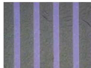
図2. ストライプ状開口を持つマスクパターン
